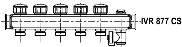
Collettore di ritorno in acciaio inox AISI 304 con valvole termostattizzabili - cappello di regolazione, rubinetto di carico/scarico e sfiato aria.
