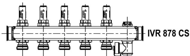
Collettore di mandata in acciaio inox AISI 304 con misuratore-regolatore di portata, rubinetto di carico/scarico e sfiato aria.
