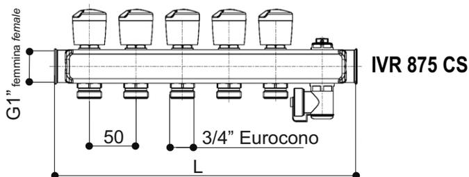
Collettore di ritorno o mandata in acciaio inox AISI 304 con rubinetti d'intercettazione, rubinetto di carico/scarico e sfiato aria.
