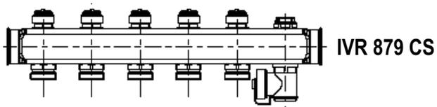
Collettore di mandata in acciaio inox AISI 304 con detentore micrometrico, rubinetto di carico/scarico e sfiato aria.
