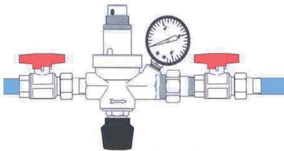
Una corretta installazione dell'alimentatore automatico IVR 334, si prevede l'inserimento di una valvola a sfera a monte ed una a valle dell'apparecchio.
