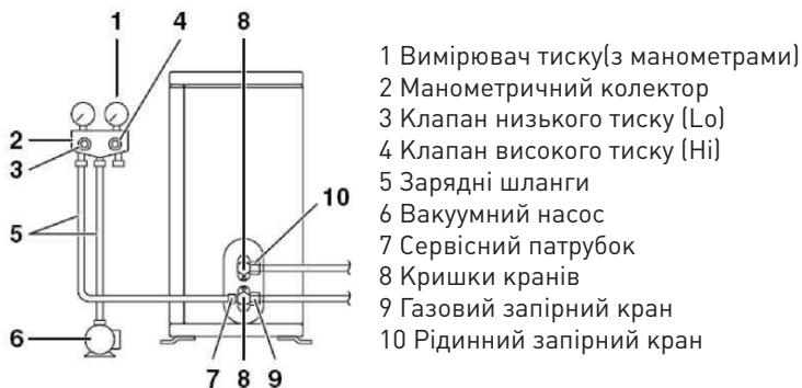
Мал.61 Схема використання обладнання для заправки фреоном
