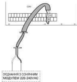
Мал.35 З'єднання з сонячною панеллю. З'єднати з комплектом для сонячної енергії вхід 220-240 В перемінного струму (AC)
