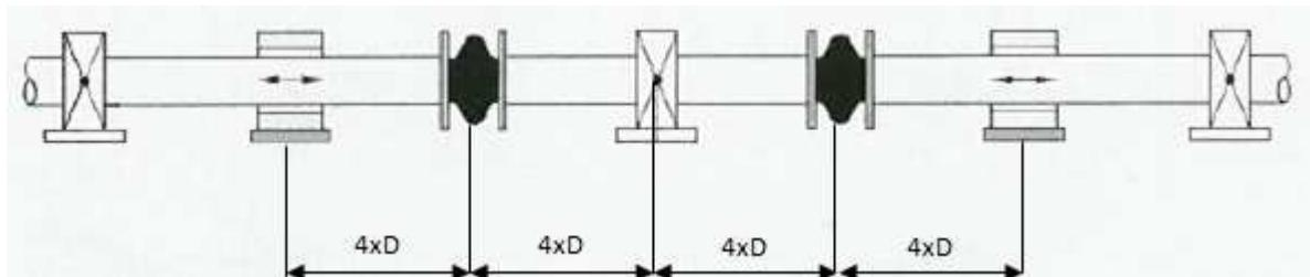
В случае применения последовательно двух передвижных опор расстояние между ними может составлять  $14 \times D$ , где  $D$  – диаметр трубы.
