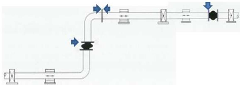
В случае монтажа компенсатора вблизи насоса, расстояние от компенсатора до патрубка насоса должно составлять  $1,5 \times DN$ .
